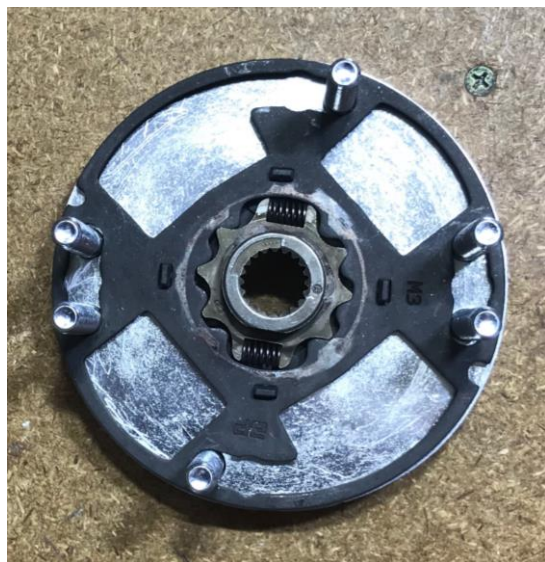
モータ軸 x トランスミッション軸カプラー(アルミ10・5・3mm厚板から切り出し) クラッチプレート内蔵部品(スプライン部)も分解し再利用
