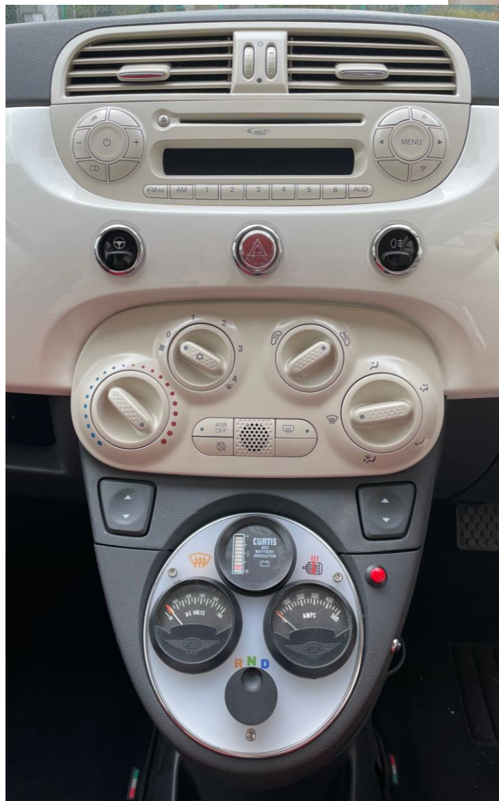
センターコンソール(計器・シフトダイヤル)
