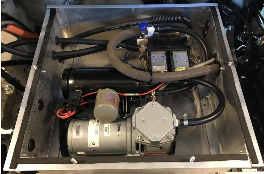
ボンネット内の高電圧ボックス内部 (高電圧リレー・真空ポンプ・真空タンク)
