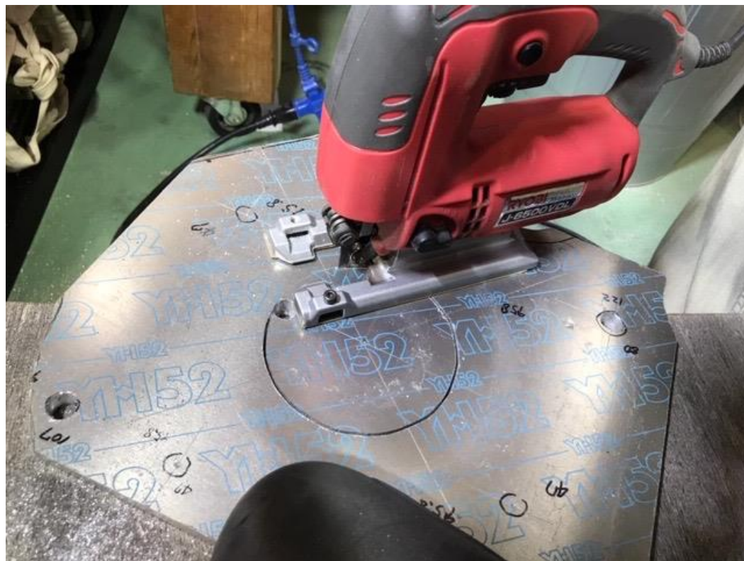
モータxトランスミッション結合プレート (アルミ10mm厚板から切り出し)
