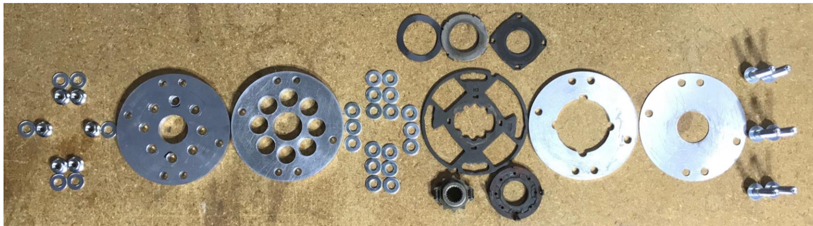
モータ軸 x トランスミッション軸カプラー(アルミ10・5・3mm厚板から切り出し) クラッチプレート内蔵部品(スプライン部)も分解し再利用
