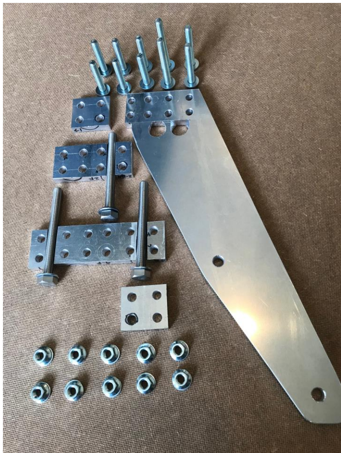
右モーターマウント (アルミ10mm厚板から切り出し)
